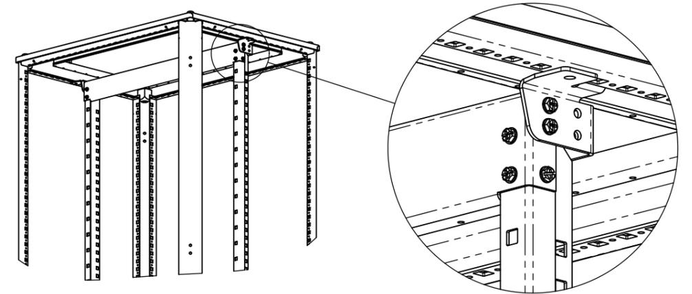
Монтаж рамы модульной на шкаф осуществляется при помощи самонарезающих винтов (поставляются в комплекте).
