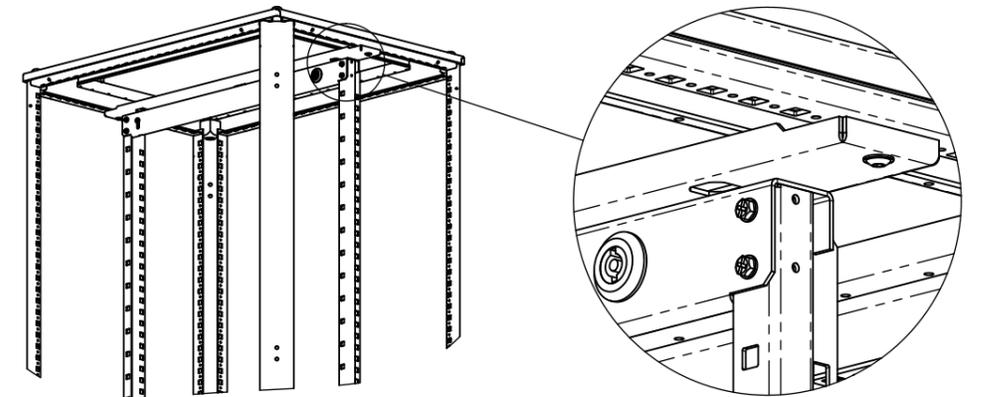
Монтаж рамы поворотной на шкаф осуществляется при помощи закладных гаек и винтов М6 (поставляются в комплекте).
