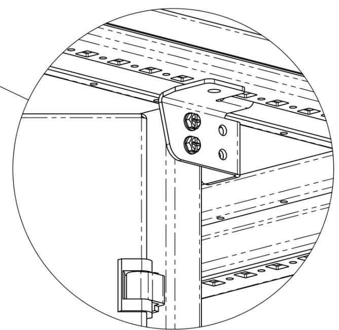
*Монтаж профиля двери на раму шкафа осуществляется при помощи самонарезающих винтов (поставляются в комплекте).*
